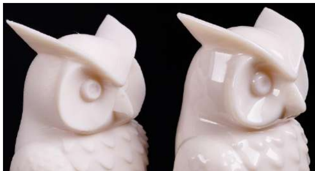
Gambar 1. 1 Layer Pada Hasil Cetak 3D print FDM sebelum dan sesudah dihaluskan sumber : https://encrypted-tbn0.gstatic.com/images
