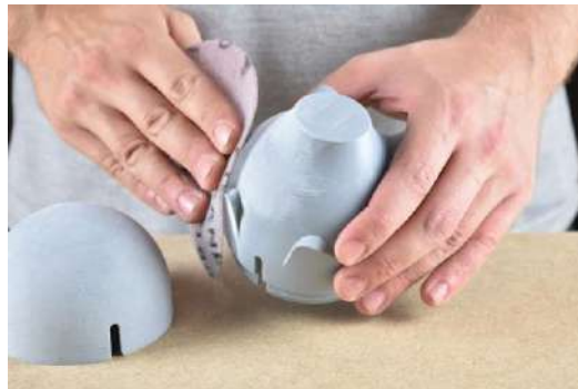
Gambar 1. 2 Post processing mekanis dengan metode sanding sumber : https://static.cytron.io/image/tutorial
